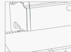
Мал. 8. В 3-й отвір з права, вставте виступ утримувача при перфоратії на пластикову пружину, або в 4-й отвір, при перфоратії на металеву пружину.
